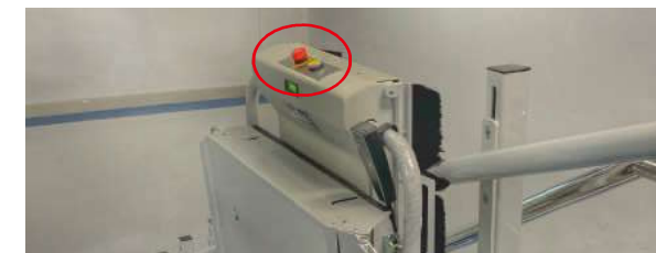
非常停止スイッチ 緊急時に非常停止スイッチを押すと即座に動作が停止します。スイッチを開放すると簡単に復旧します。
